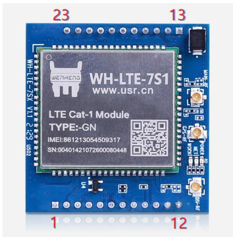
图片 2 引脚标号 (TOP View)
